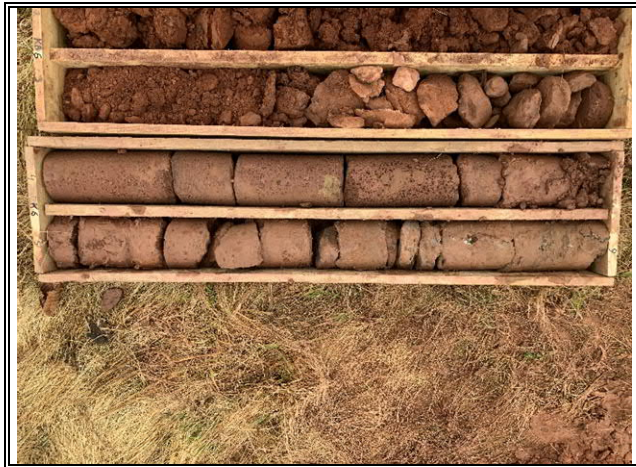
Bohrkerne Bohrung BK 6, 5-7 m
