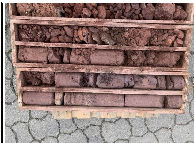
Bohrkerne Bohrung BK 8, 5-8 m
