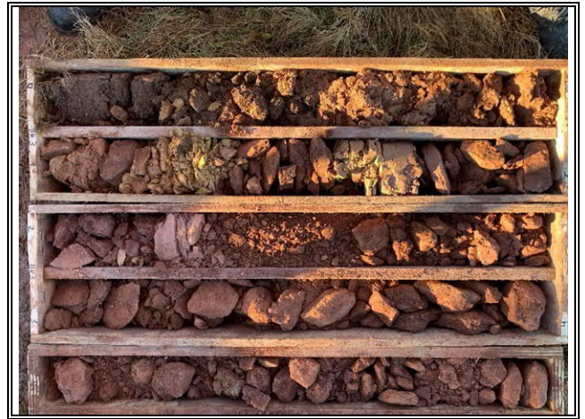
Bohrkerne Bohrung BK 3, 0-5 m
