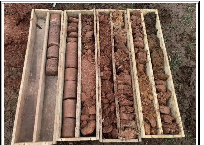
Bohrkerne Bohrung BK 4
